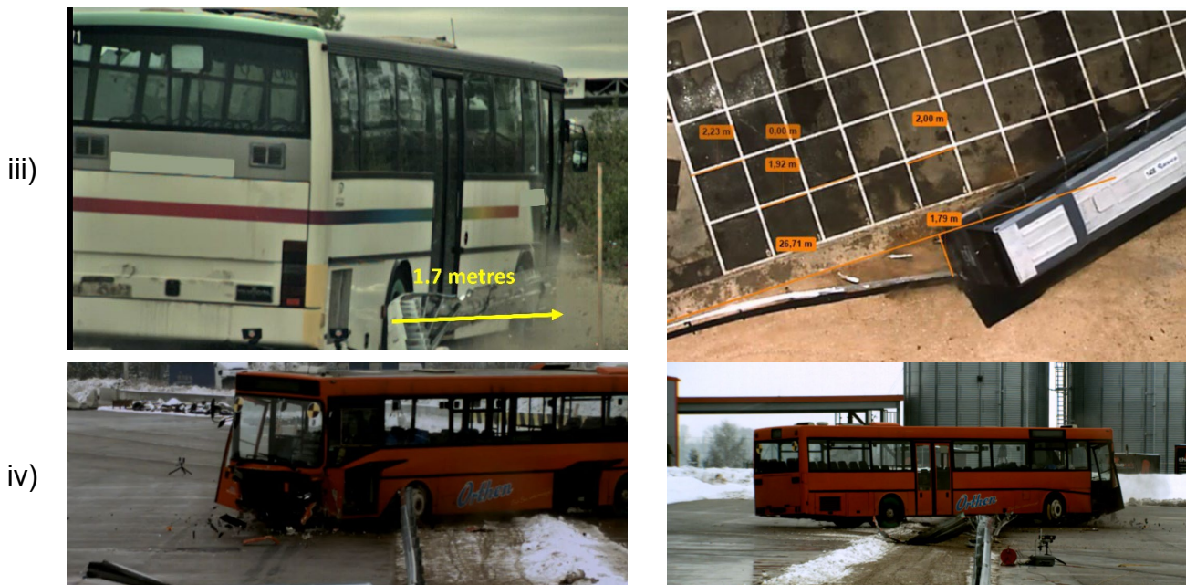
Schéma 5 - H2-W4- test de collision (de la rangée supérieure à la rangée inférieure) : i) 1er essai, véhicule non confiné, ii) 2ème essai, véhicule non confiné, iii) 3ème essai, le système dépasse la largeur de travail de 2 classes, iv) 4ème essai, véhicule non confiné
