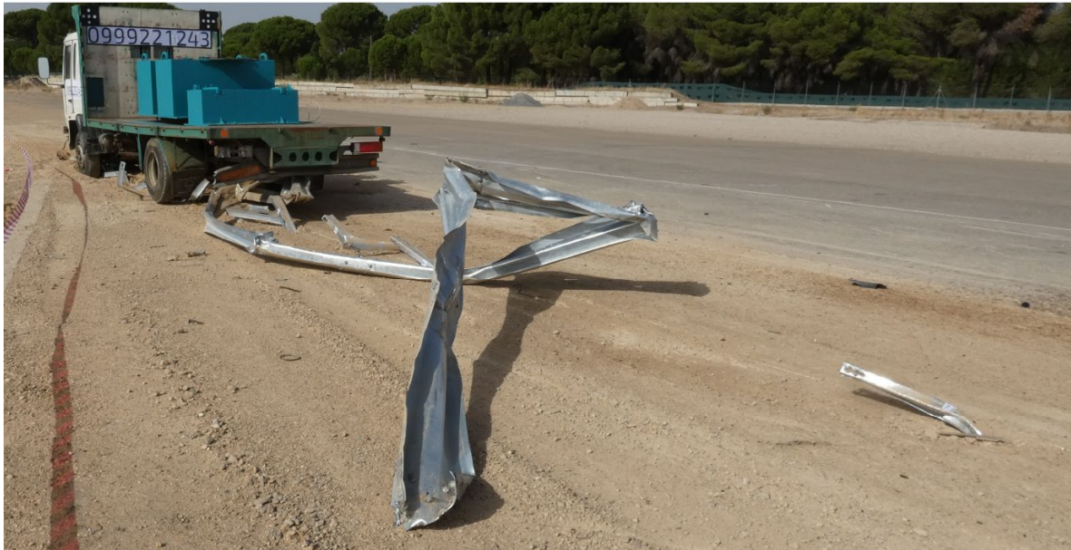
Schéma 8 - Croquis TB42 de la zone d'impact (en haut), résultat de l'essai de choc avec la barrière déformée (en bas)
