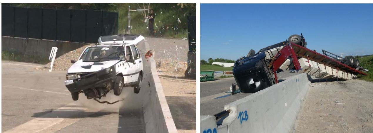
Schéma 7 - Résultat de test de collision TB11 avec une valeur ASI de 1,53 (g.), résultat de l'essai de choc TB81 avec un véhicule renversé (d.)
