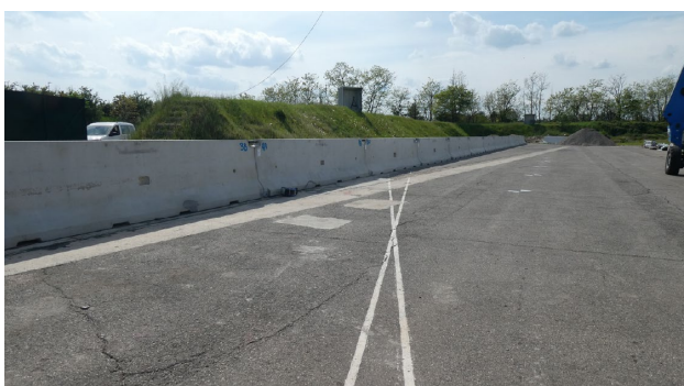
Figura 6 – TB81 Barrera de hormigón probada (izq.) y croquis de la zona de impacto (dcha.)
