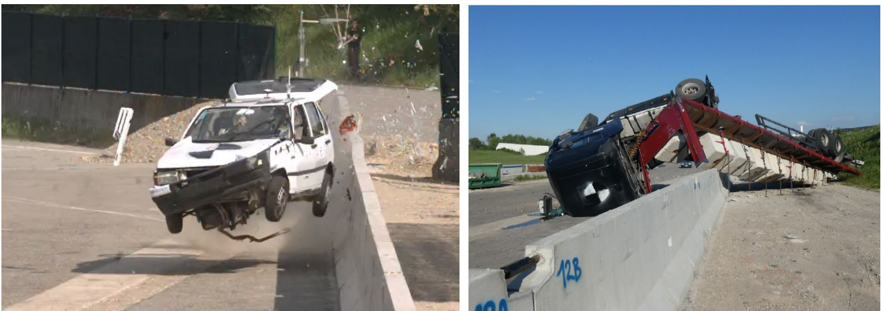
Figura 7 - resultado del ensayo de choque ASI valor 1,53 (izquierda), resultado del ensayo de choque TB81 con vehículo de choque volcado (derecha)
